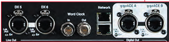
本体のgigaACEポートは、MixRackとの接続用です。I/O拡張ラックとの接続には、DX Linkまたはオーディオ・ネットワーキングカードM-DL-GACE (gigaACEカード) (→p.21) をご使用ください。
