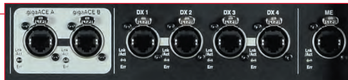
本体のgigaACEポートは、Surfaceとの接続用です。I/O拡張ラックとの接続には、DX Linkまたはオーディオ・ネットワーキングカードM-DL-GACE (gigaACEカード) (→p.21) をご使用ください。
